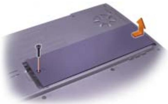
**SUGGERIMENTO:** se il modulo di memoria non è installato correttamente, il computer non si avvia, ma non viene visualizzato alcun messaggio di errore.
